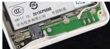
下方的PCB板上主要是一些功能性的模块,右侧白线是高频电子线,负责信号传输工作;左侧银色物件就是震动马达,黑灰色是耳机插孔模块,震动马达和耳机插孔中间的小物件就是麦克风。
